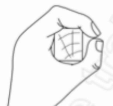
Las barras y asideros, diseñados para ser apuñados, deberán tener sección transversal entre 16 y 45 mm.
