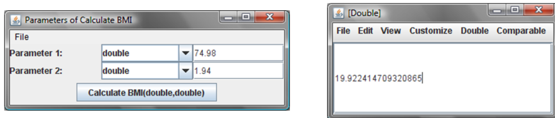
Figure 11. Entering actual parameters and invoking calculateBMI
