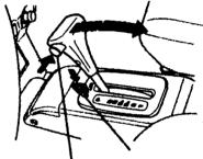
SHIFT LOCK RELEASE BUTTON RELEASE SLOT
